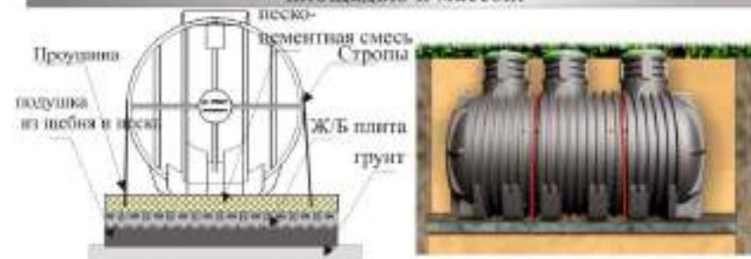
Рисунок 13. Схема установки подушки под плиту основание
